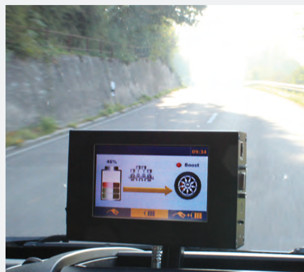
Abbildung 2: Bedienpanel zur Umschaltung zwischen den Betriebsmodi. Von Links : Verbrenner-Modus, Elektro-Modus (aktiv), Hybrid-Modus
