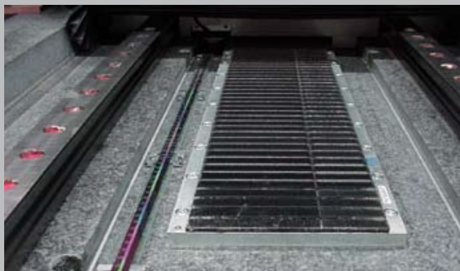
Linearmotoren im Einsatz bei der hochpräzisen Feinstbearbeitung
