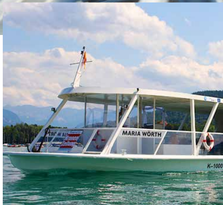
Projektbeispiel: elektrische Binnenfähre
