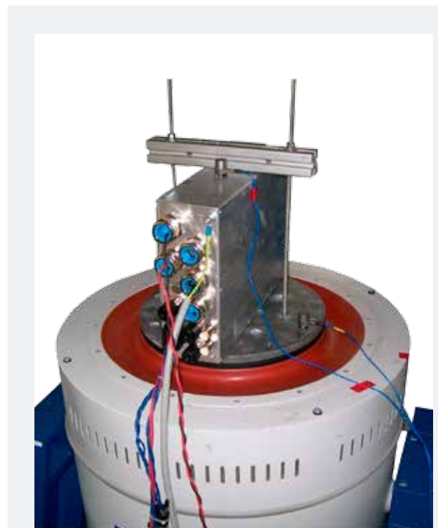
Teststand: Schock- und Vibrationsprüfung
